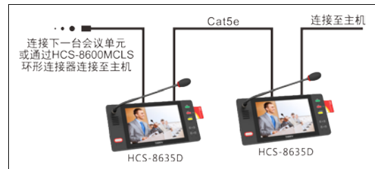
图 3.4.6 HCS-8635 系列简约型多媒体终端之间的连接
