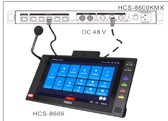
图 3.2.11 HCS-8638/8669/8668 系列无纸化多媒体会议终端与千兆网交换机的连接 (非 PoE 模式)
